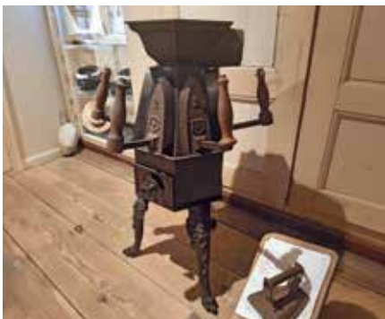
Bügeleisenofen für mehrere heisse Bügeleisen
