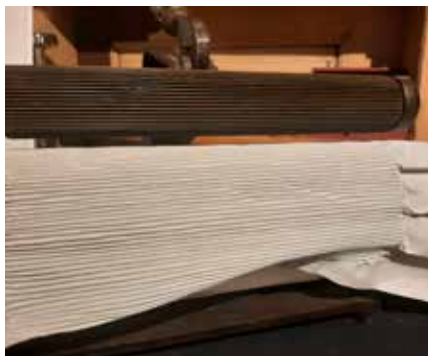
Gaufrierwalze, um die mit Kartoffelmehl gestärkten Hemden festlich zu machen
